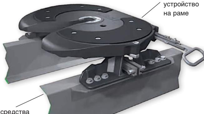
Седельно-сцепное устройство устанавливается на раму тягача посредством монтажной плиты. Имеется большой выбор высот седельно-сцепных устройств и монтажных плит. За счет этого возможен точный подбор высоты седельного устройства под полуприцеп.
